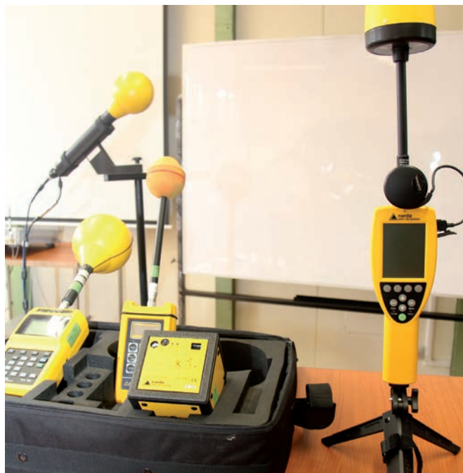
Medidor selectivo de campos electromagnéticos SRM – 3006 (9 kHz a 6 GHz). Este equipo es empleado en el monitoreo de radiaciones no ionizantes para telecomunicaciones, combinando las funciones de un analizador de espectros para banda angosta y las de un medidor de banda ancha. Su valor aproximado es cien mil dólares.
