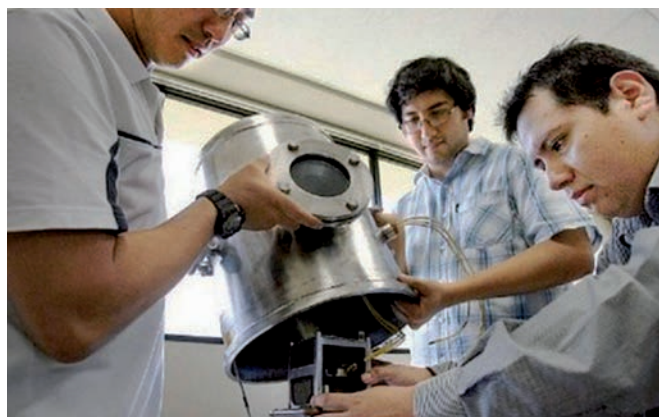
Cámara de vacío construida en la UNI para probar el nanosatélite.
