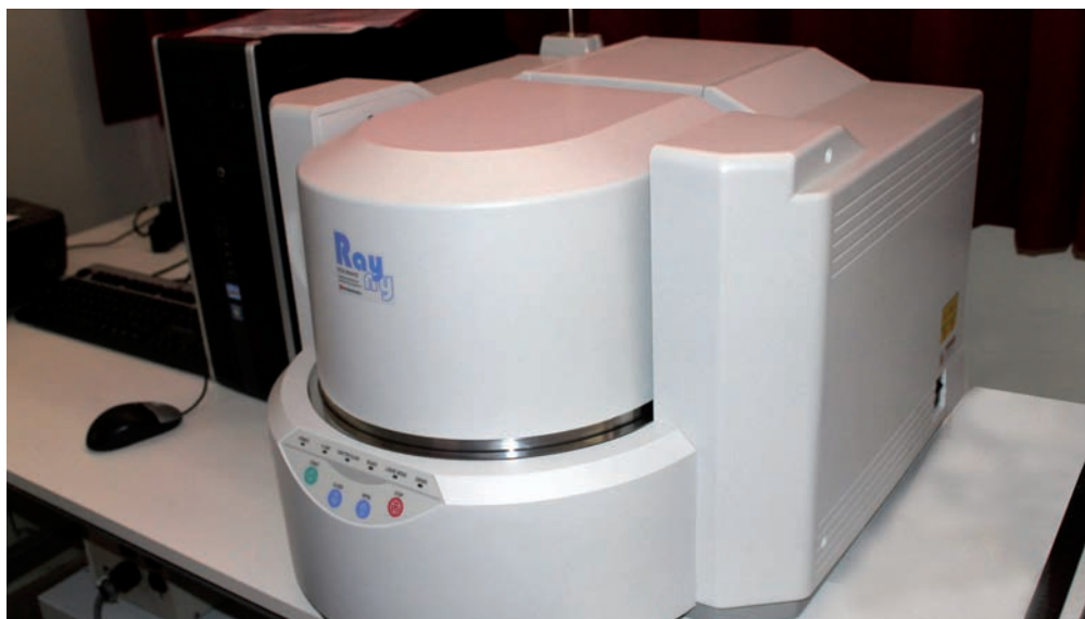
Espectrómetro de fluorescencia que permite hacer pruebas no destructivas para detectar metales.
